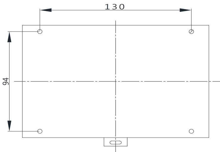
Рисунок 4 – Разметка для крепления БВР24 саморезами
